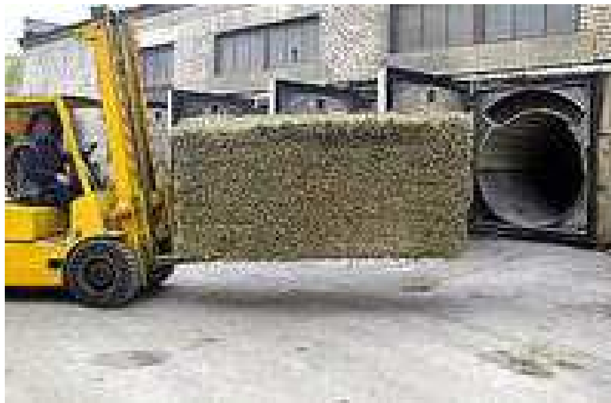
1.2.6. att. Saulaines 1,36 MW katlu māja ar 4 kurtuvēm veselu ķīpu sadedzināšanai.
