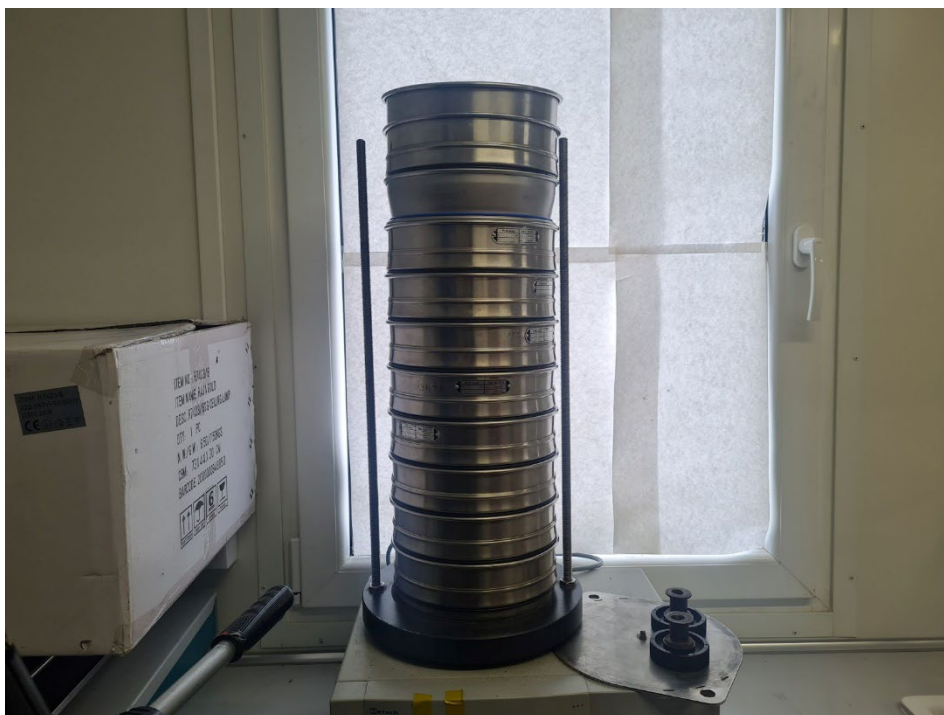
3.3. attēls. Sijātājs Retsch GmbH AS 200 smilšu granulometriskā sastāva noteikšanai (Foto: A. Bebrīte)
