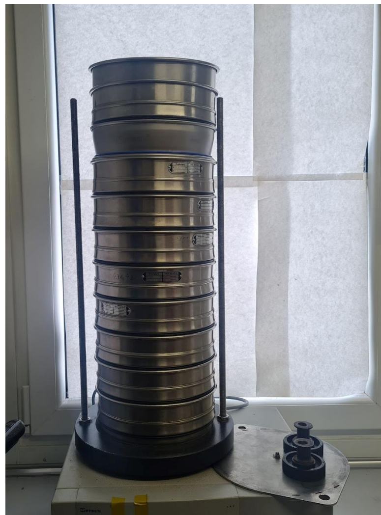
Sijātājs Retsch GmbH AS 200 smilšu granulometriskā sastāva noteikšanai
