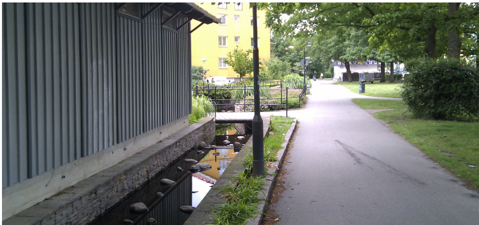
68. attēls. Kanāla novietojums Lonngatan ielas telpā. Kanālā ievietoti laukakmeņi, kas sekmē ūdens aerāciju. Avots: autoru arhīvs
